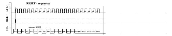
Fig. 6e: RESET sequence (21-Bit)
