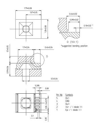
Bond Pads: Aluminium, 100 um in width Cavity depth: 100 um
